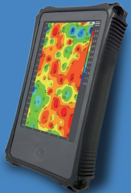
AMC-10型无线高精度三分量磁力仪是我公司联合上海海事大学等多个机构研制而成，内置高精度磁通门传感器和姿态传感器，不仅可测量X、Y、Z三轴向磁场数据，而且具有倾斜状态下测量地磁水平分量和垂直分量的能力，可省去人工调整水平的繁琐操作。X轴方位角可以实时数字显示，转角精准达到0.01°。测量软件植入磁场自动修正算法，通过出厂时测试调整的50几个修正系数在现场测量时自动修正直显测量结果。仪器操控主机与仪器数据采集探头完全无线连接，在操作过程中省略连线干扰，便捷高效。仪器操控主机直接显示测量结果、曲线和等值线彩图，数据与PC电脑无线同步。该仪器可直接测量X、Y、Z三分量磁场数据和X∠、Y∠、Az角度数据，并且能实时计算ΔZ、ΔX、ΔY、ΔH、ΔT数据，利于现场判断和后期数据分析。
