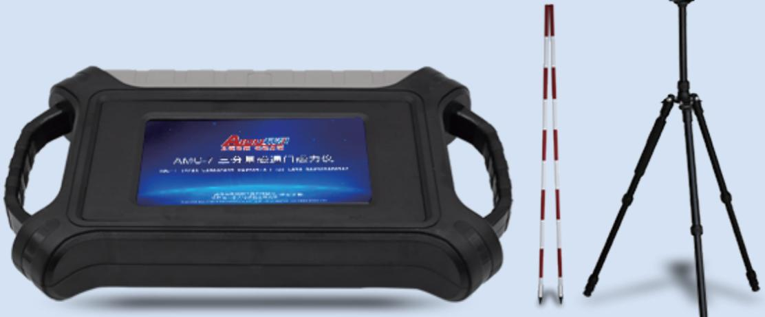
AMC-7型三分量磁力仪的探头采用高性能坡莫合金铁芯激励线圈的三颗高性能传感器机械水平悬挂，可测量X、Y、Z三个方向的磁场及总场，具有分辨率高、精度高、性能稳定、温漂小等特点。
