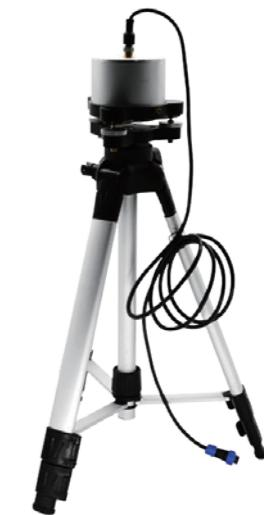
AMC-6型磁通门探矿仪是上海艾都与上海海事大学合作的杰作，采用高导磁率坡莫合金经特殊的热处理后的磁芯，纯手工绕制的高性能传感器，在交变激励信号的磁化作用下，磁芯的导磁特性发生周期性饱和与非饱和变化，使围绕在磁芯上的感应线圈感应输出与外磁场成正比的信号，通过特制高性能的电路转化磁场强度变化，分辨率达到0.1-1nT，专业款转向差高达±20nT，对微弱信号变化量的反应能力相当高，具有分辨率高、精度高、性能稳定、无温漂等特点。
